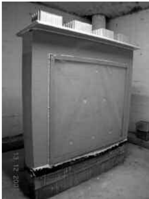
Fotografía n°2: Impermeabilización de la zona de ensayo en el procedimiento CIDEMCO CO-115
