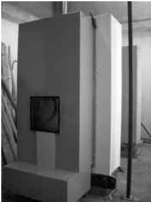
Fotografía n°4: Equipamiento de ensayo para el procedimiento UNE-EN 12865:2002
